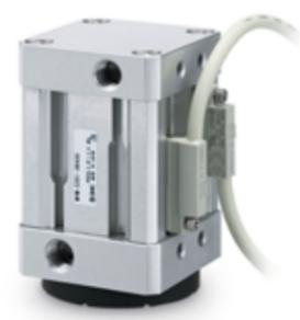
einsetzbar. Ihr Innenleben ist einfach und hochfunktional: An einem beweglichen Kolben ist ein Magnet angebracht, der sich durch Druckluftzufuhr in Richtung Werkstück bewegt. In dieser Stellung wird das Werkstück aufgenommen und sicher fixiert. Die Freigabe wird über eine zweite Druckluftöffnung ausgelöst: einströmende Druckluft schiebt Kolben und Magnet vom Werkstück weg.
