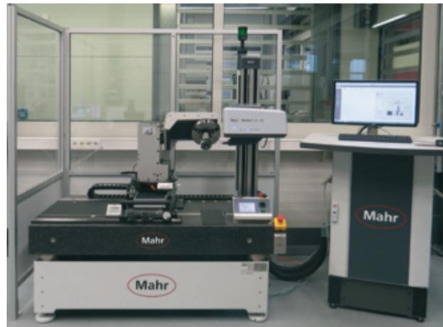
automatisiertes Messen von Rauheit auf der Zahnflanke. Überprüft werden kann an dem Messplatz die Rauheit der Außenverzahnung sowohl bei Schrägverzahnung als auch bei Geradverzahnung.
