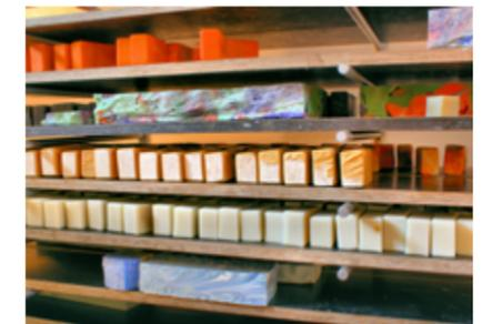
**Bis zu einem halben Jahr reifen die fertigen Seifen. Erst nach dieser Zeit sind alle chemischen Reaktionen abgeschlossen.**
