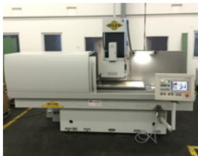
etwa beim Nachschleifen in Reparaturwerkstätten oder zum Planschleifen im Form- und Werkzeugbau zum Einsatz kommen. Sie werden Eins-zu-Eins auf den Technikstand von heute umgerüstet, der Funktionsbereich bleibt identisch. Diese Alt-Maschinen werden durch die Überholung der Mechanik und Steuerung wieder fit für den Gebrauchtmachinesmarkt gemacht. Nach der Überholung kann die
