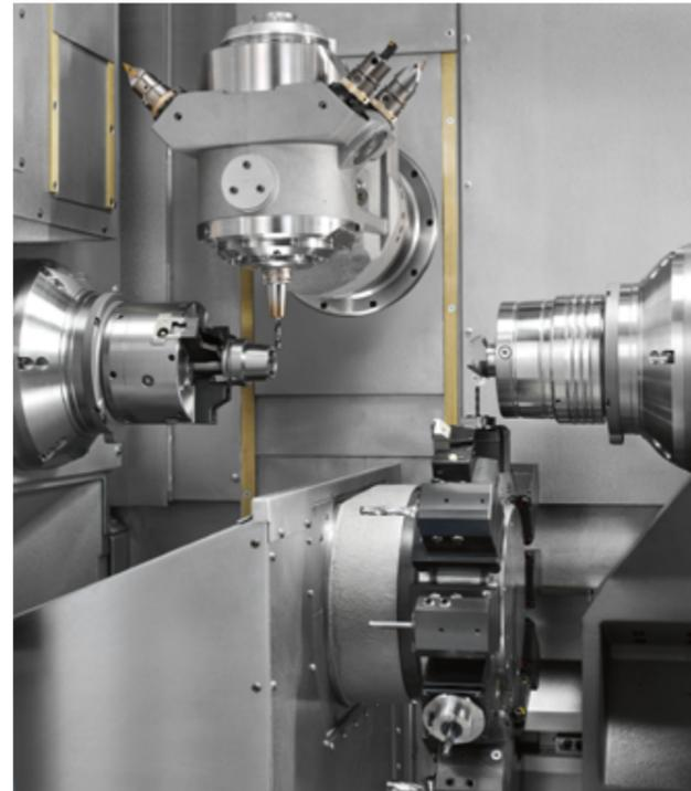
Der Werkzeugrevolver ist mit 18 oder 12 Stationen verfügbar und besitzt eine Y-Achse mit einem Verfahrbereich von  $\pm 50$  mm.
