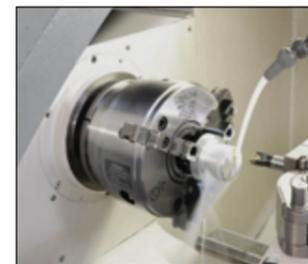
Gleitflächen modifiziert und der Sicherheits-Sperrschieber überarbeitet. Das Keilstangenprinzip bietet eine konstant hohe Spannkraft und ein sehr gutes Fliehkraftverhalten. Die Rund- und Planlauf-toleranz ist doppelt so genau wie es die DIN-Genauigkeitsklasse 1 vorschreibt. Konkret heißt das für die Größe 250: Wo die DIN-Norm eine Genauigkeit von 0,06 Millimeter fordert, leistet das Duro-T 0,03 Millimeter.
