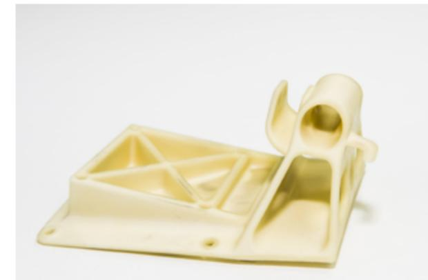
Perfekt für den Guss: Die 3D-gedruckten PMMA-Modelle wurden mit Wachs infiltriert.
