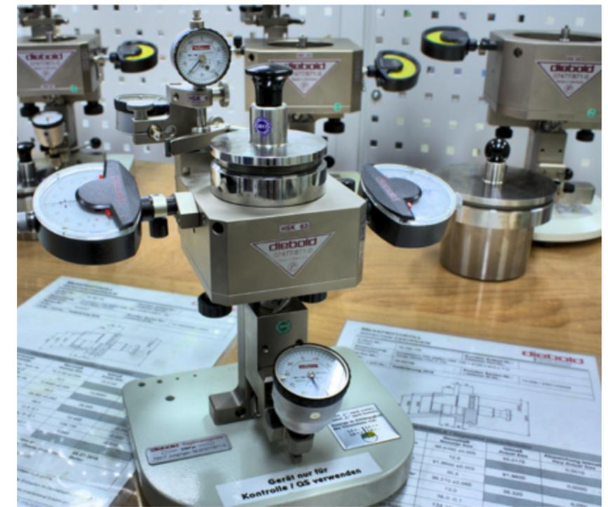
Das Kegelmessgerät von Diebold wird mittels eines Einstellorns geeicht. Dazu werden alle Messuhren nach dem Einstecken des Messdorns einfach auf Null gestellt.
