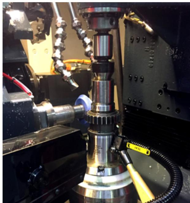
Mit Ringspanns Spanndorn »HDDS« sind Zahnräder in der Verzahnungsqualitätsstufe 4 nach DIN 3961 schleifbar.
