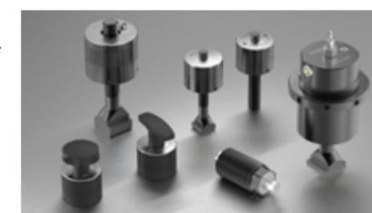
zu 350 kN zur Verfügung. Die Hydraulikversorgung muss dabei nur beim Ein- und Ausbau dieser Produkte vorhanden sein, im Betrieb wird die Axialkraft rein mechanisch durch ein Tellerfederpaket gehalten. Diese innovative Spanntechnik bietet somit eine echte Alternative sowohl zu einfachen Spannmitteln wie Spanneisen und Prätzen aber auch zu halb- und vollautomatischen Spannelementen mit ihren aufwendigen Energieversorgungs- und Steuerungssystemen.
