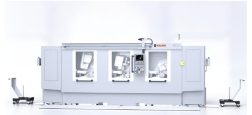
Die Produktionsanlage »CC 355« von Vollmer bearbeitet hartmetallbestückte Kreissägen in einem Arbeitsgang über drei Bearbeitungsstationen.
