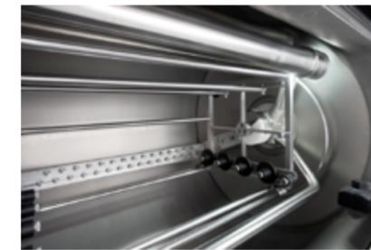
Je kleiner und empfindlicher Bauteile sind, desto schwieriger wird ihre Reinigung. Daher hat Mafac ein neues Ultraschallreinigungsverfahren entwickelt und die Korb-Düsenrotation darauf übertragen. Daher ist der Ultraschallschwinger ebenfalls rotierbar und erreicht durch die Rundumbewegung um das Korbaufnahmesystem eine noch bessere Verteilung der Schallwellen innerhalb der Kammer. Die Bauteile werden von allen Seiten beschallt und Schattenzonen deutlich redu-
