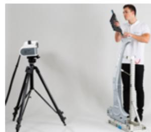
licht Messungen mit totaler Bewegungsfreiheit, während die Moveinspect-Software zu jedem Zeitpunkt die 3D-Koordinaten von Objektpunkten oder die sechs Freiheitsgrade von Festkörpern bestimmt. Probleme durch Vibrationen, Lärm oder Positionsänderungen werden durch die „Dynamische Referenzierung“ gelöst. Das Moveinspect XR8 vereinfacht außerdem Montageprozesse, und kann sogar teure Einbaulehren ersetzen.
