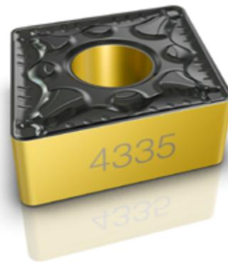
keit gegen plastische Verformung bietet. Darüber hinaus sorgt die neue Aluminiumoxid-Beschichtung, die als Wärmesperre dient, für eine besonders effiziente Wärmeabfuhr aus der Schneidzone. Die säulenförmige MT-TiCN-Beschichtung bietet eine verbesserte Widerstandskraft gegen Abrasionsverschleiß; die gelbe TiN-Deckschicht auf den Freiflächen ermöglicht eine einfache Verschleißerkennung. Sandvik Coromants neue GC4335-Sorte ist als T-Max P sowie als CoroTurn 107-Wendeschneidplatte erhältlich.
