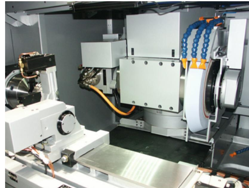
Der Schleifkopf verfügt über eine – optional zwei – große Schleifscheiben zum Rund- und Planschleifen. Außerdem gibt es eine Innenschleifspindel.
