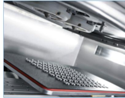
In rund drei Stunden fertigt ein Freeformer aus dem Hochtemperatur-Kunststoff »PEI« eine Kleinserie von 70 Abstandshaltern für Allrounder-Spritzgießmaschinen.
