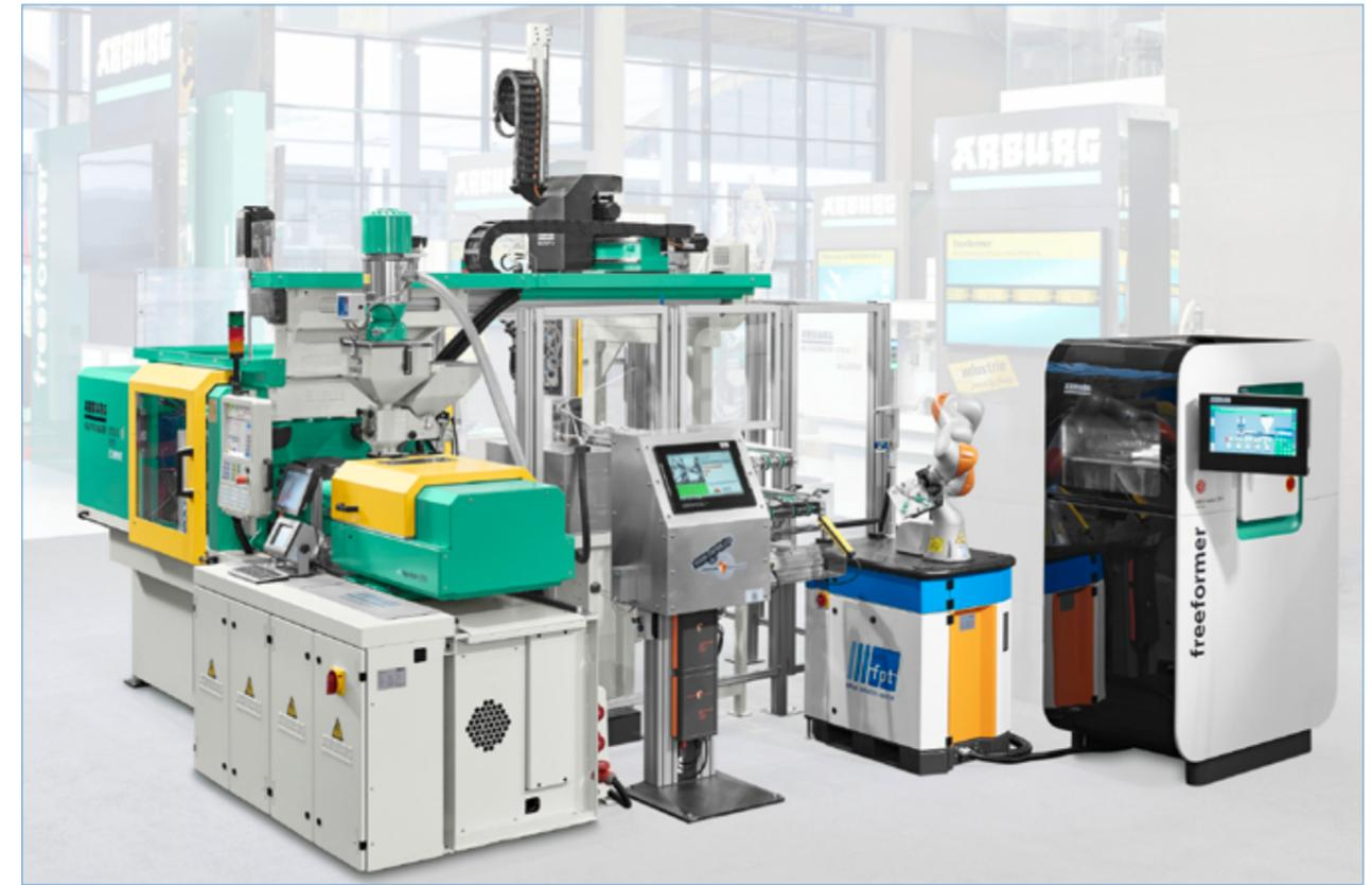
Bei einer informationstechnisch komplett vernetzten und durchgehend automatisierte Fertigungslinie für individualisierte Großserienteile bestückt ein Sieben-Achs-Roboter den Bauraum des Freeformers.
