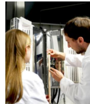
dem sogenannten »Power-to-Syngas«-Verfahren wird Wasserdampf und Kohlendioxid zu Synthesegas umgewandelt. Dabei handelt es sich um ein Gemisch aus Kohlenmonoxid (CO) und Wasserstoff. Die Co-Elektrolyse von CO<sub>2</sub> könnte dazu beitragen, die Emission von Treibhausgasen signifikant zu reduzieren. Anders als Gasgemische aus fossilen Brennstoffen ist das Endprodukt bereits weitgehend frei von Schwefel- und Stickstoffkomponenten, die sonst aufwendig entfernt werden müssen.
