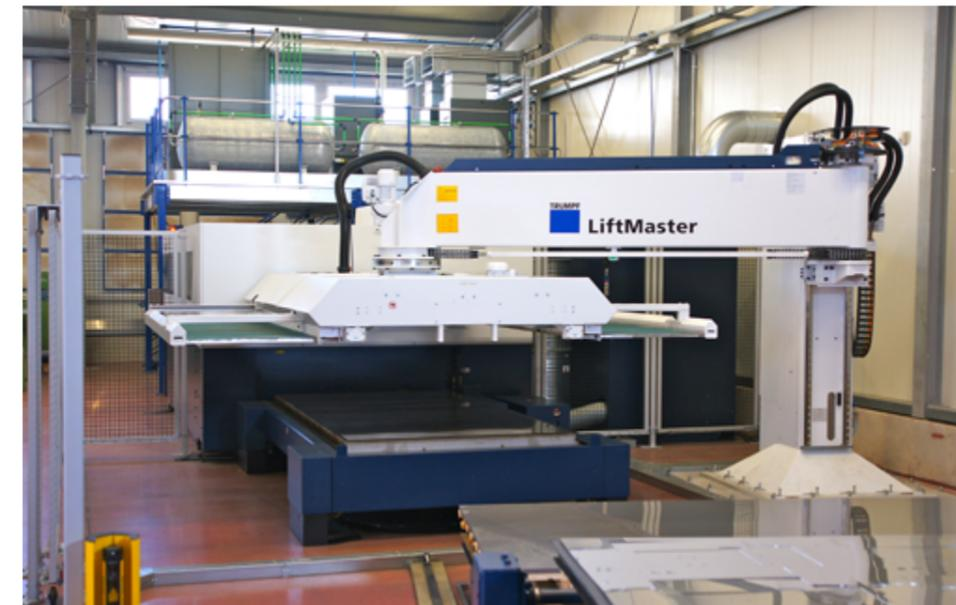
Die automatische Laserschneidmaschine benötigt neben technisch öfreier Druckluft auch hochreinen Stickstoff der Klasse 5.0 mit einem Druck von 30 bar.
