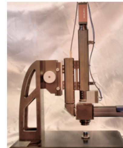
Bei dem smartWLI-Sensor mit großem Arbeitsabstand von vier Zentimeter ist der Aufbau des Interferometers mit Referenzstrahlengang, Lichteinkopplung und Kamera klar erkennlich.
