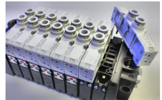
Mit nur einem Werkzeug sind Ventile der ESO5-Serie rasch und problemlos umbaubar.
