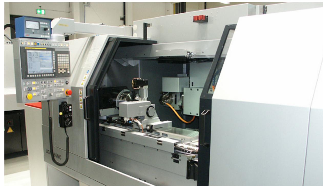
Mit den CNC-Universal-Rundschleifmaschinen ›UGM360NC‹ beziehungsweise ›UGM3100NC‹ stellt Okamoto höchst produktive und vielseitige „Präzisions-sprinter“ zur Verfügung.
