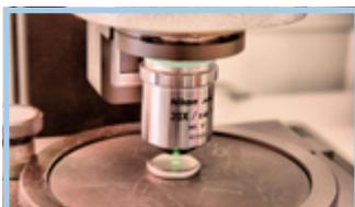
Die Interferometrie erlaubt sehr präzise Oberflächenanalysen. 90
