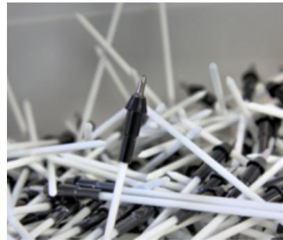
Zwischen 0,4 und 1,4 Millimeter Durchmesser messen die Kugeln, die in der Kugelschreiberspitze verbaut sind.
