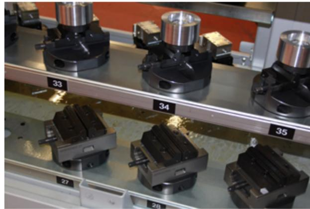
Die Beschickung aus dem Magazin erfolgt frei nach Programm und damit „chaotisch“.
