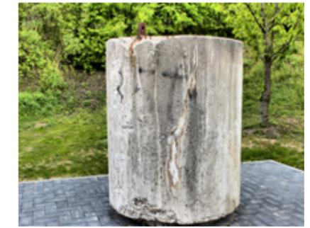
Zur stärkeren Abschirmung wurden Stahlfässer mit Beton ummantelt. Dazu wurde Normal- und Schwerbeton verwendet.
