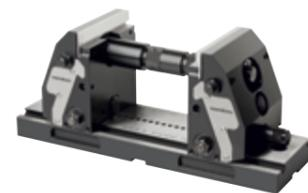
der Maschinentisch verspannt sich nicht. Die besondere Spanntechnik erhöht die Steifigkeit der Spannung für den Einsatz höchster Schnitt- und Vorschubkräfte. Der Fünffachs-Spanner ist mit einer Backenbreite von 90 und 125 mm erhältlich. Einspannweiten sind von 20 bis 320 mm möglich. Die Einspannweite kann theoretisch unendlich verlängert werden. Der Spanner kann auf T-Nutentische, Rastersysteme sowie auf gängige Nullpunkt-Spannsysteme montiert werden.
