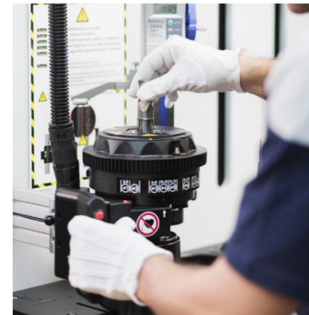
Einfacher und jederzeit wiederholbarer Schrumpfvorgang: Für jedes Schrumpffutter sind im »Power Clamp Premium« bereits alle benötigten Parameter hinterlegt.
