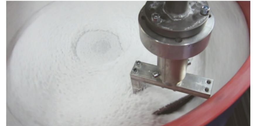
Mit dem Streamfinishing-Verfahren von Otec lassen sich Rauigkeiten bis  $R_a 0,1 \mu\text{m}$  erreichen, weshalb es nicht zuletzt für Turbinenschaufeln geeignet ist.
