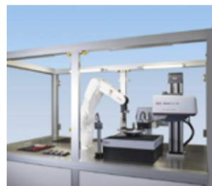
produktspezifischen Messungen durch. Selbsttätig und frei von Bedienfehlern fährt der Taster die Messpositionen an. Anschließend identifiziert die Lese- und Markierstation das Werkstück und bringt mittels Laser eine weitere Markierung in Form einer Nummer an – sie beinhaltet unter anderem die Qualitätsgüte. Anschließend deponiert der Roboterarm das Teil in der Ablagestation. Die Messdaten können natürlich via Bus-system gespeichert werden.
