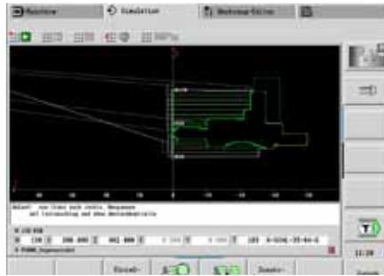
Eine Simulation der Rückseitenbearbeitung dokumentiert, ob das Teil korrekt zerspant wird.
