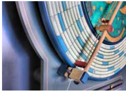
Wichtige Voraussetzung, um einen Zeiger an bestimmte Positionen des Ziffernblatts zu bewegen ist eine Spirale.
