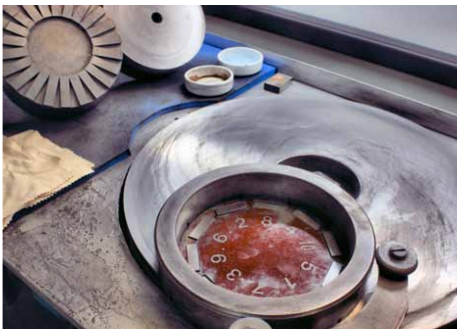
Viel Handarbeit ist für die Endmaßfertigung nötig. Keine maschinelle Anlage ist in der Lage, die Endmaßfertigung zu automatisieren.
