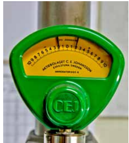
Mechanische Messinstrumente, die noch den Bruchteil eines Tausendstel Millimeters anzeigen können, sind für die Endmaßfertigung gerade gut genug.
