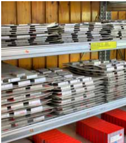
Beste Hartmetallrohlinge namhafter Hersteller bilden die Basis für High-End-Endmaße, die die Forderungen der Endmaßnorm DIN 3650 weit übertreffen.
