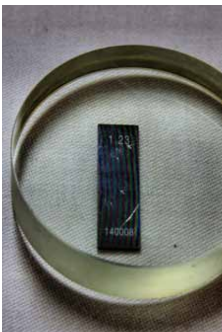
Das Planglas zeigt an, ob Oberfläche und Ebenheit des Endmaßes makellos sind.
