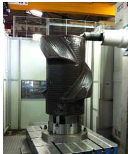
Auch beim Fräsen sorgt Inoflex für eine absolut sichere Spannung selbst langer Teile.
