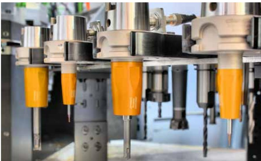
Der Jetsleeve ist rundum mit feinen Bohrungen versehen, deren Winkel an die Fräserlänge angepasst sind. So wird das Kühlmedium exakt an die Arbeitsstelle gesprüht.
