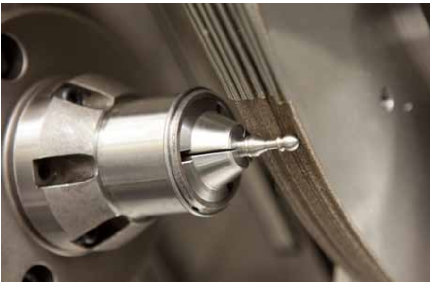
Der Einsatz einer Profilscheibe erlaubt das Einstechschleifen der gesamten Werkstückkontur und ermöglicht dadurch eine extrem kurze Bearbeitungszeit.
