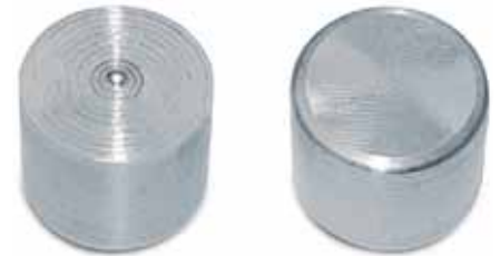
Drehmaschinen lassen oft einen Butzen in der Werkstückmitte stehen (links). Die Grindstar vermeidet dies (rechts).
