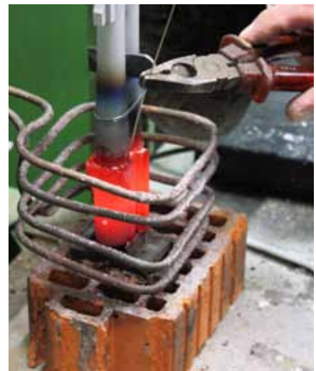
Per Induktion wird eine Temperatur von 710 Grad Celsius erzeugt und zwei Läufe mit dem „Hakenstück“ hartverlötet.
