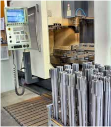
Auf modernen CNC-Maschinen werden alle Einzelteile und die Läufe der Krieghoff-Waffen präzise auf Maß gefertigt.
