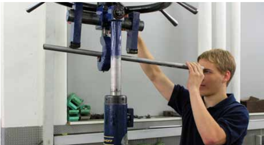
Durch Wärmebehandlungen verbiegen sich die Läufe. Diese werden bei Krieghoff von Könnern per Auge und mittels einer Presse akkurat wieder gerade gerichtet.
