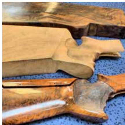
Für besondere Wünsche in Sachen Gewehrschaft hat Krieghoff ausgesuchte Rohlinge aus Nussbaumholz auf Lager.
