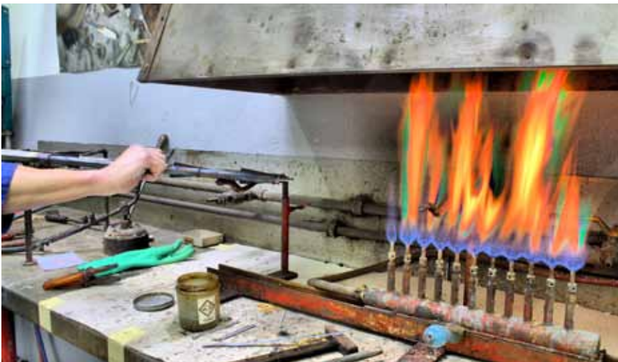
Das Weichlöten über der offenen Flamme wird dazu genutzt, mehrere Läufe fest zu verlöten. So entstehen Bockwaffen, also zweiläufige Waffen, aber auch „Drillinge“. Dieser Arbeitsgang erfordert Könnern, damit die Läufe exakt zueinander fluchten.
