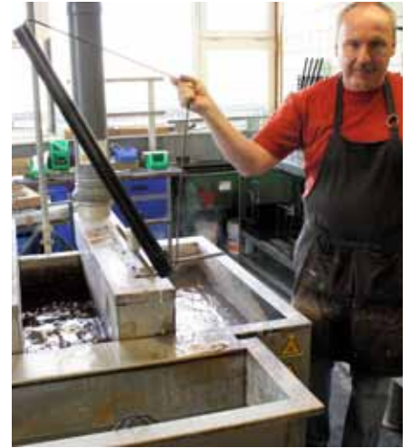
Zwei Durchgänge sind in einem 140 Grad Celsius heißen Brünier-Salzbad nötig, damit der Lauf tiefschwarz wird.
