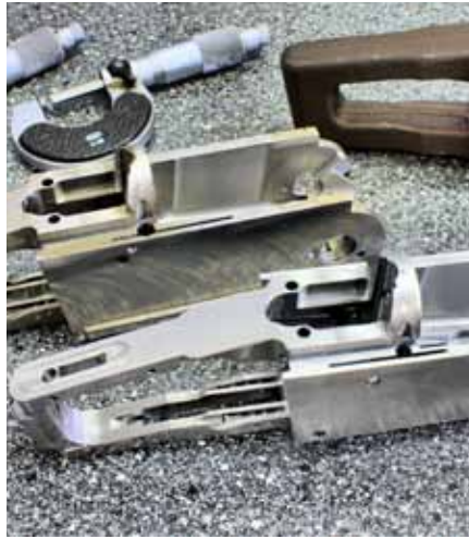
In nur zwei Aufspannungen wird auf CNC-Maschinen der Systemkasten für das Modell ›K-80‹ aus dem Vollen gefräst.
