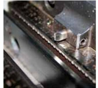
Per Prägestation werden pyramidenförmige Vertiefungen in das Werkstück eingedrückt. Der dadurch erreichte Formschluss sorgt für sicheres Spannen.
