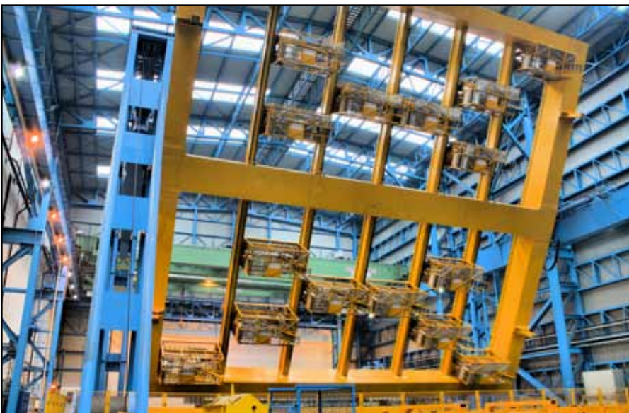
Eine Wendeeinrichtung gestattet das Drehen von bis zu 40x40 Meter großen Modulen, damit die Monteure ihre Arbeit nicht über Kopf ausführen müssen.
