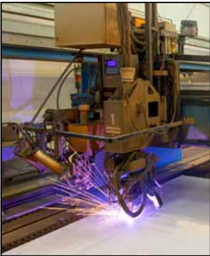
Computergesteuert werden Blechtafeln per Plasmaschneiden mit Durchbrüchen versehen und per Laserschweißen zu großen Platten verschweißt.
