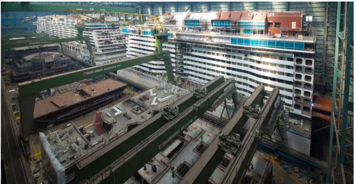
Planung bis ins kleinste Detail: Während links hinten ein Schiff fertiggestellt wird, arbeitet man bereits am nächsten Schiff, dessen Teile vorne und rechts im Bild zu sehen sind. Auf diese Weise kann die Meyer Werft pro Jahr zwei Kreuzfahrtschiffe bauen.
