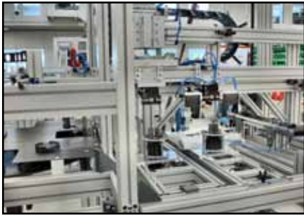
Bausteine von Fremdherstellern, wie etwa Pneumatikzylinder, Schrittmotoren oder Greifer, sind problemlos integrierbar.
