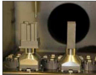
Elektroden werden vom 3D-CAD-Modell des zu bearbeitenden Bauteils mit ›Visi Elektrode‹ abgeleitet und konstruiert.
