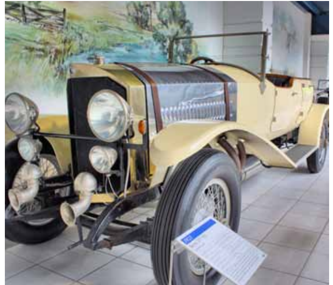
Mit einem Verbrauch von 50 Liter auf 100 Kilometer war der Benz 27/70 kein Sparwunder, was zur damaligen Zeit jedoch niemand störte, da Autos hauptsächlich repräsentative Aufgaben hatten.
