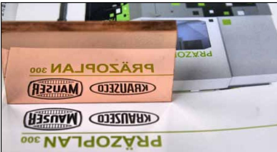
Mit dem Präzoplan gefräste Oberflächen besitzen eine derart geringe Rautiefe, dass die so produzierten Teile direkt für optische Zwecke verwendet werden können.
