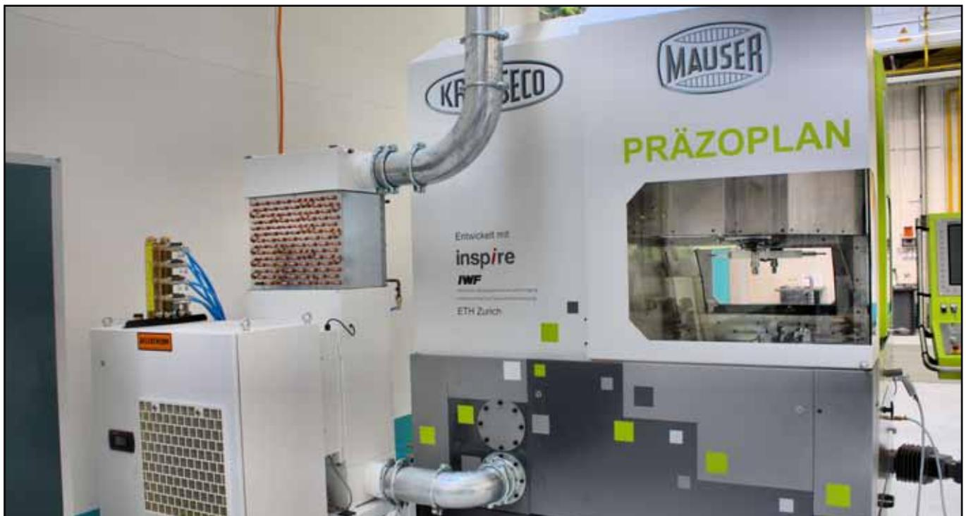
Die voll gekapselte Maschine verfügt über ein Thermokonzept. Die abgesaugte, warme Luft wird vom Arbeitsraum in ein Klimagerät geleitet, wo sie auf 20 Grad Celsius heruntergekühlt und danach zum Kühlen der Maschinenelemente genutzt wird.
