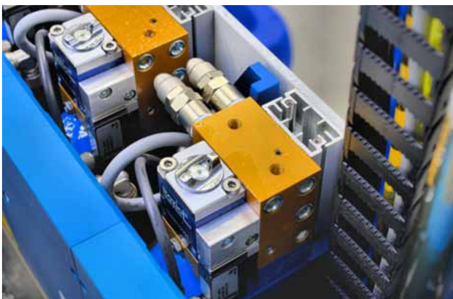
Kompakte, pneumatische Teleskopzylinder erlauben das Ein- und Ausfahren der Düsen. Auf diese Weise sind Bleche unterschiedlichster Breite problemlos beöhlbar.
