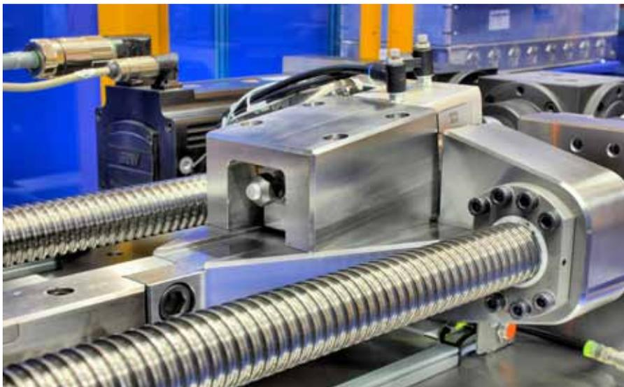
Die 3,5 Tonnen schwere Maschine ist kräftig dimensioniert, was problemlos Flächenpressungen von bis 2500 N/mm<sup>2</sup> erlaubt. Werkzeugeinsätze verschiedenster Geometrien und Materialien erlauben das Nachstellen unterschiedlicher Fälle, um das für den jeweiligen Zweck optimal formulierte Öl zu finden.
