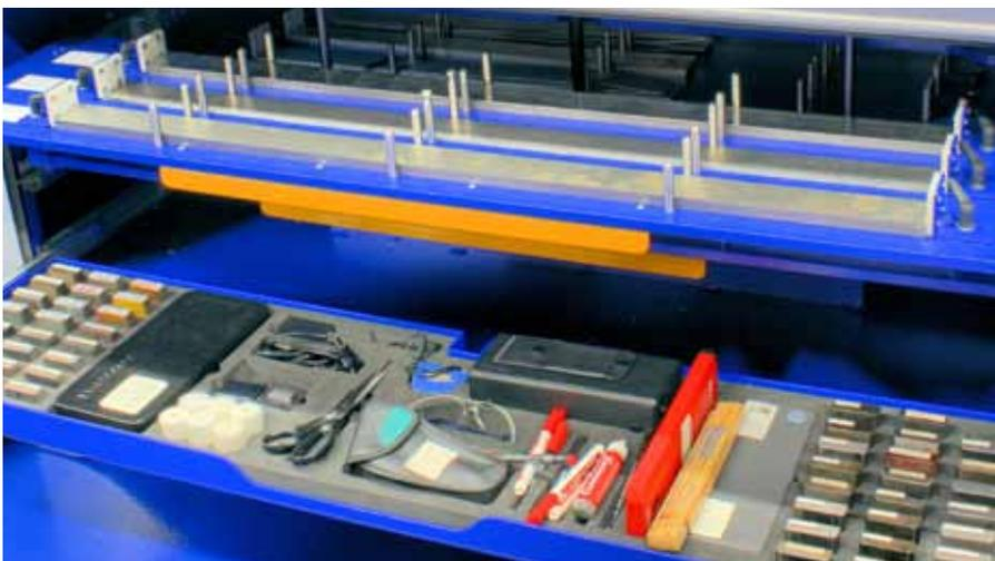
Ein wohlüberlegt eingeteilter Schrank nimmt alle für die Tribologieprüfung nötigen Zubehörteile und Prüfmittel auf.
