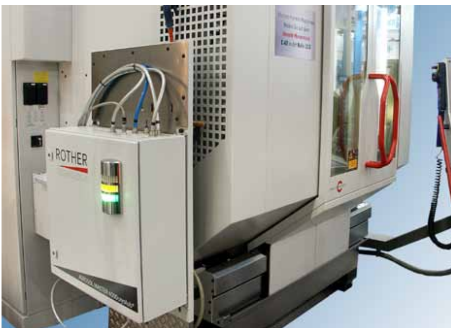
Rother hat mit ›ATS‹ ein System auf den Markt gebracht, das auf der Minimalschmier-technik basiert, jedoch viel kleinere Tröpfchen erzeugt. Der Unterschied ist enorm.
