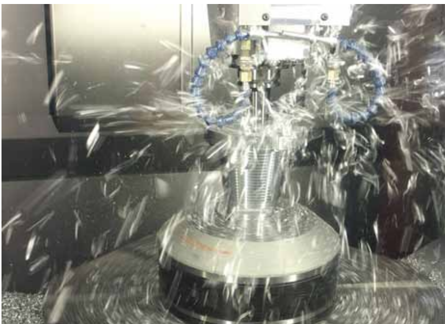
Rother's ATS-System erzeugt besonders feine Öltröpfchen. Durch deren große Oberfläche wird Hitze effektiv abgeleitet und die Arbeitsstelle perfekt geschmiert.
