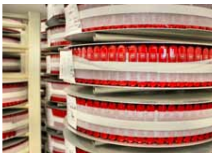
Zur automatisierten Weiterbearbeitung werden Griffschalen aus dem eigenen Kunststoffwerk auf einer Rolle geliefert.
