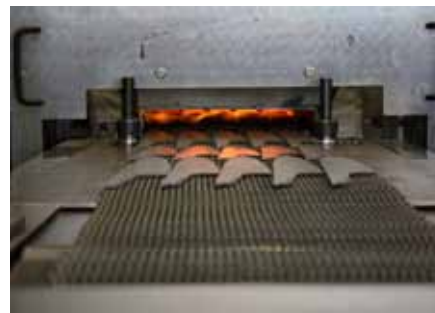
Messer von Victorinox werden für eine hohe Schnitthaltigkeit gehärtet, was in speziellen Öfen und Anlagen geschieht.
