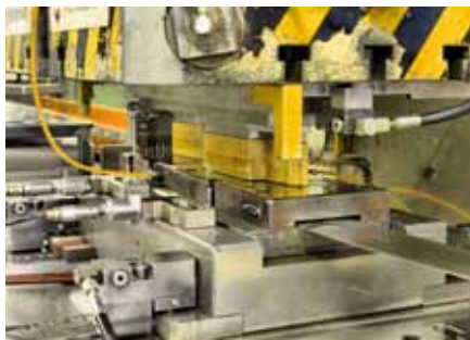
Stanzmaschinen sind die erste Maschinengattung, mit denen der Messerstahl in Berührung kommt.
