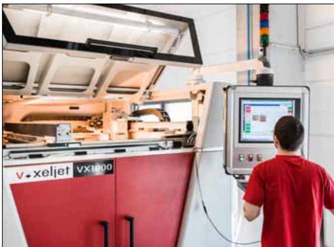
Mit einer ›VX1000‹ von Voxeljet wird Kunststoffgranulat mit Phenolharz gebunden und zum Werkstück aufgebaut.
