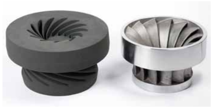
Die Vielseitigkeit der Voxeljet-Maschinen erlaubt sowohl die Produktion von Abformteilen, als auch von Sandgussformen, was die Einzelfertigung von einsatzfähigen Gussteilen erlaubt.
