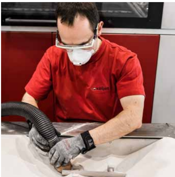
Nachdem der Bauprozess beendet ist, wird das überschüssige Kunststoffgranulat mit einem Industriesauger abgesaugt.
