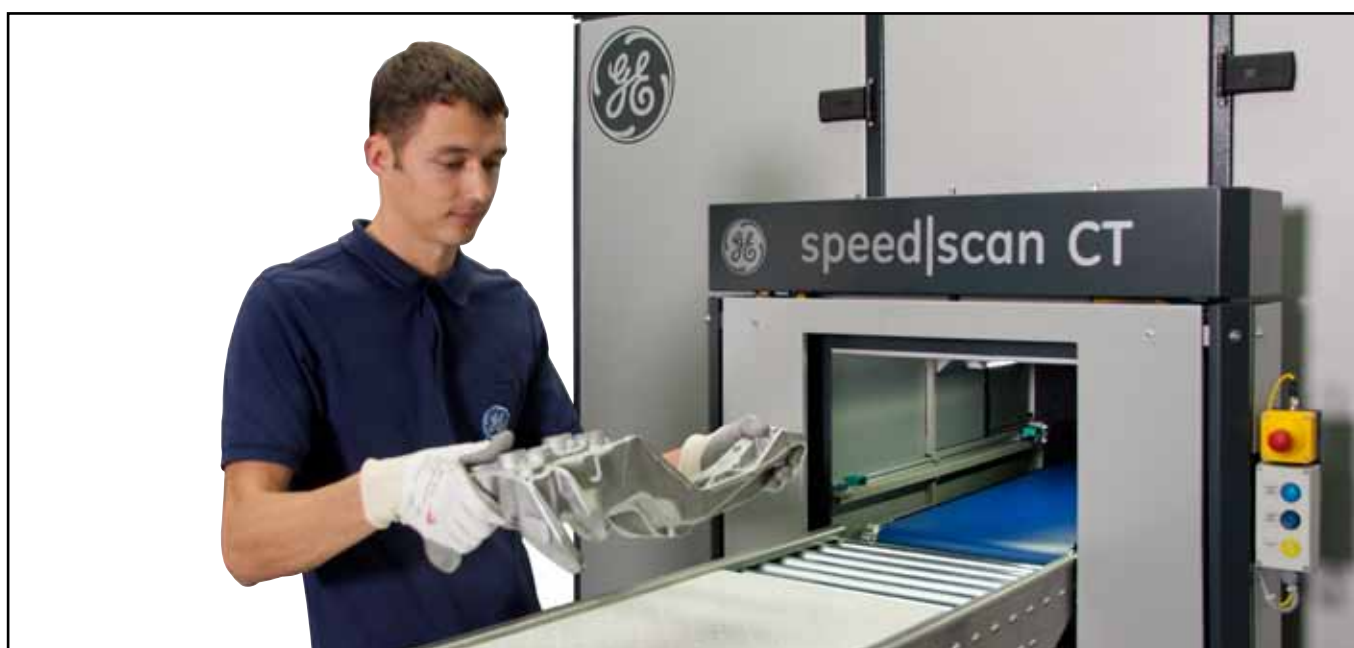
Schnelle atlineCT: das neue speedscan CT-System von GE erlaubt eine bis zu 100 Prozent sichere 3D-Prüfung von Gussteilen und Kompositbauteilen.
