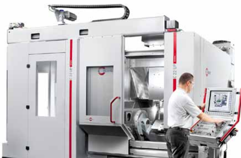
Das Bearbeitungszentrum C 22 U dynamic von Hermle besitzt einen seitlich adaptierten Palettenwechsler. Dieser ist in der Lage, Transportgewichte von bis zu 250 Kilogramm zu befördern.
