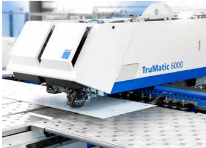
Die Trumatic 6000 von Trumpf vereint die Vorteile von Stanzen und Lasern in einer Maschine
