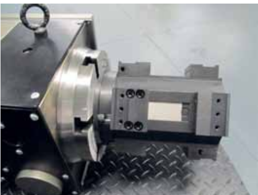
Mehrfachspannung auf 4. Achse mit Monoblock- turm solinos 65-4V. Extrem kleiner Störkreis.
