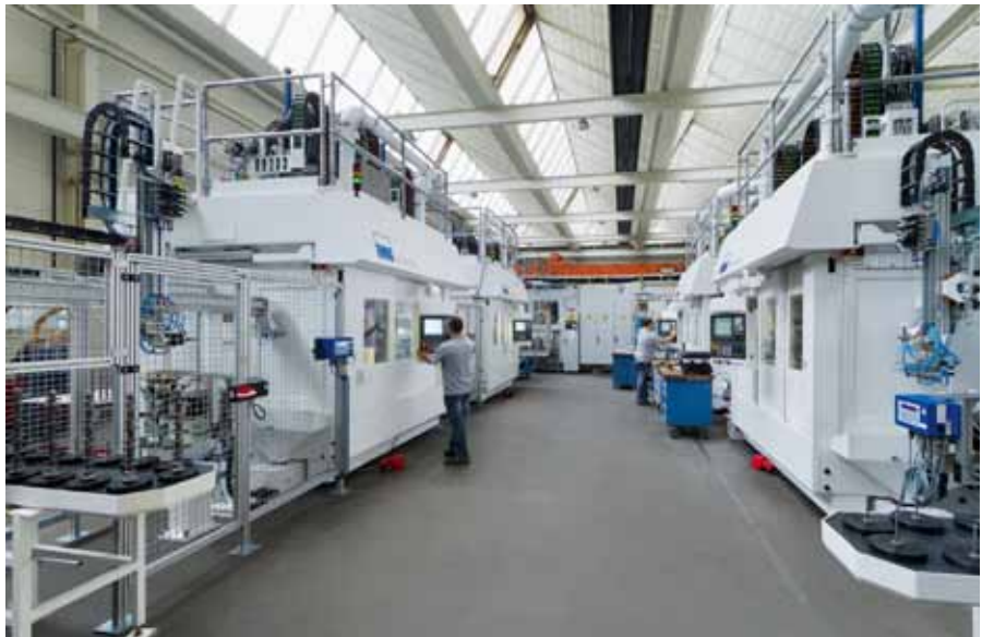
Fertigungssystem zur Komplettbearbeitung von Nockenwellen. Von der Weichbearbeitung bis zum Schleifen – alles auf der VTC-Plattform.
