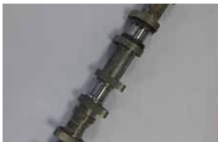
Nockenwellenquerbohrung: vor- und rückwärtsentgratung in einem Durchlauf
