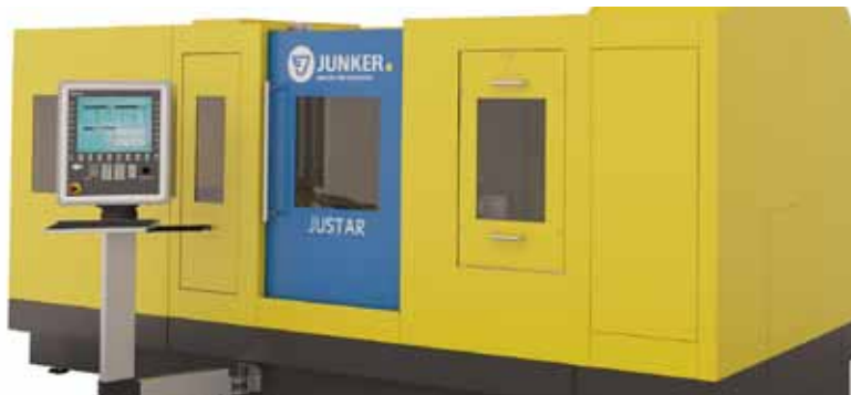
In die Justar von Junker ist ein vollautomatischer Schleifscheibenwechsler integriert
