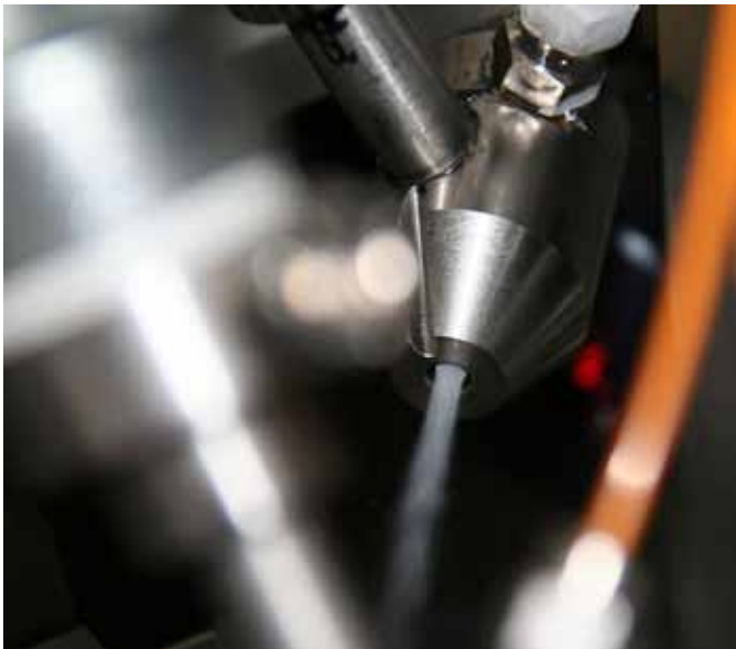
Der gut fokussierbare CO 2 -Strahl entfernt filmische und partikuläre Verunreinigungen von den Sensoren
