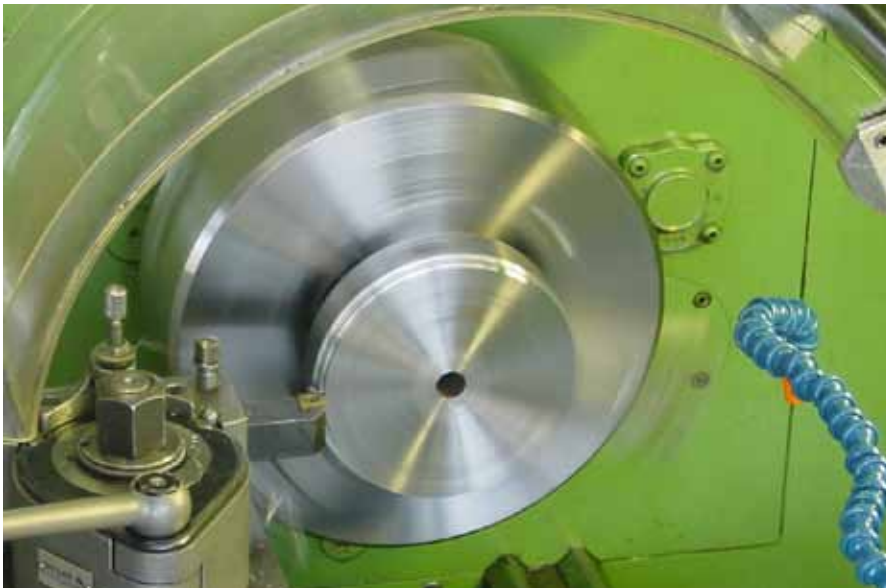
Beim Drehen führt das Werkstück die alles entscheidende Drehbewegung aus, auf die sich der Begriff ›Schnittgeschwindigkeit‹ bezieht.
