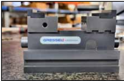
centrinos: Eine lange Führung sorgt für nur minimales Abheben beim Spannen
