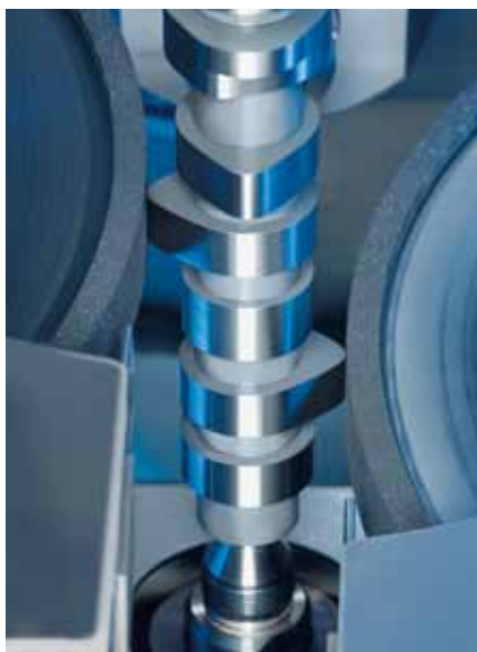
Komplexe Geometrien wie Nockenkonstruktionen können mit dem Synchro-Stützsleifverfahren bearbeitet werden
