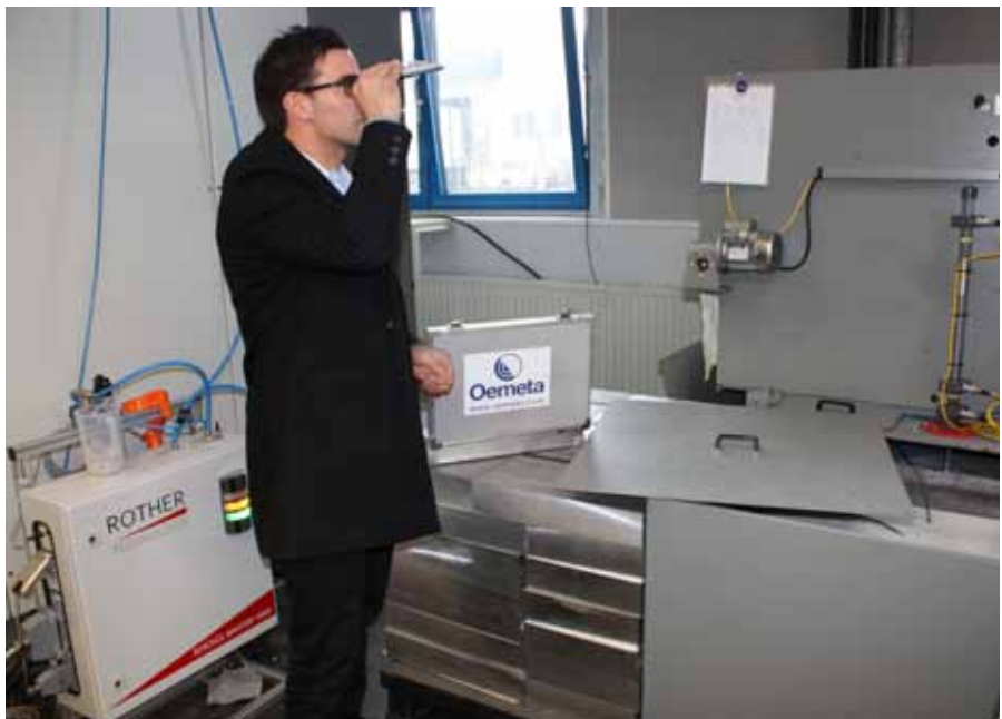
Marco Concilio, Gebietsverkaufsleiter von Oemeta, ermittelt die Einsatzkonzentration von Novamet 910 und leitet im Bedarfsfall Maßnahmen ein, die dafür sorgen, dass der KSS langzeitstabil bleibt.
