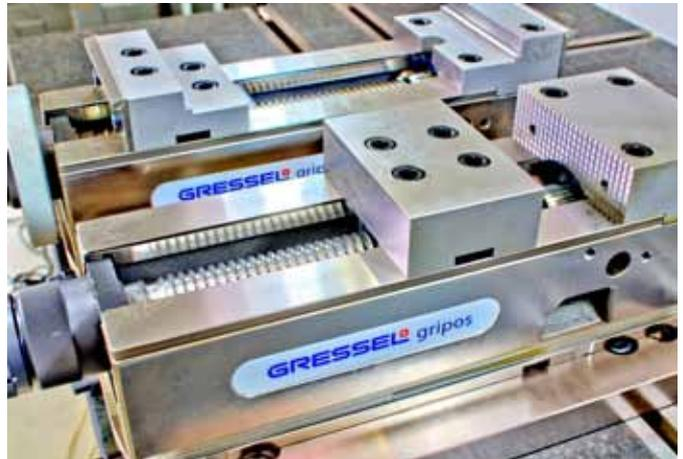
Zwei Gressel-gripo-Spanner nebeneinander sorgen für das gleichzeitige Bearbeiten zweier unterschiedlicher Teile.
