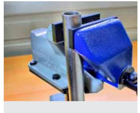
**Gressels AX-Schraubstock-Serie eignet sich besonders zum Spannen von Rohren.**
