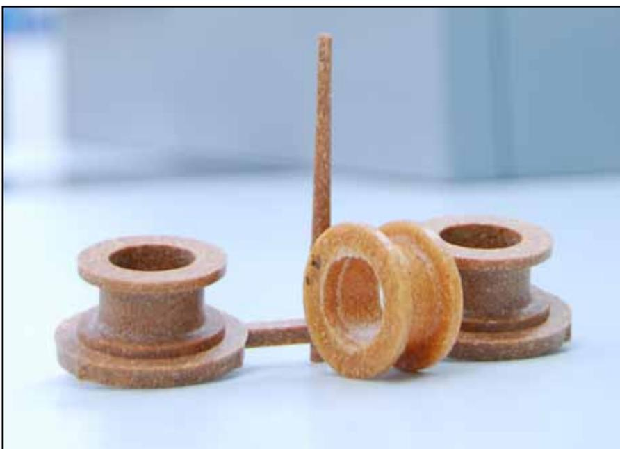
Wood-Plastic-Composites sind neuartige thermoplastisch verarbeitbare Werkstoffe, die aus unterschiedlichen Anteilen von Holz, Kunststoffen und Additiven bestehen.
