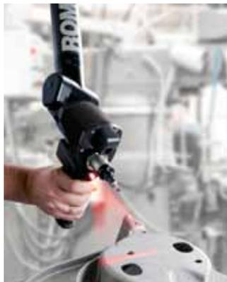
kommen kabellosen Betrieb ohne Kompromisse in Bezug auf die Geschwindigkeit der Datenübertragung. Um den kabellosen Betrieb an jedem Ort sicher zu gewährleisten, ist der Wireless Scanning Pack außerdem mit einem speziellen Akkusystem ausgestattet, das den fixen Akkutausch während des laufenden Betriebs erlaubt.
