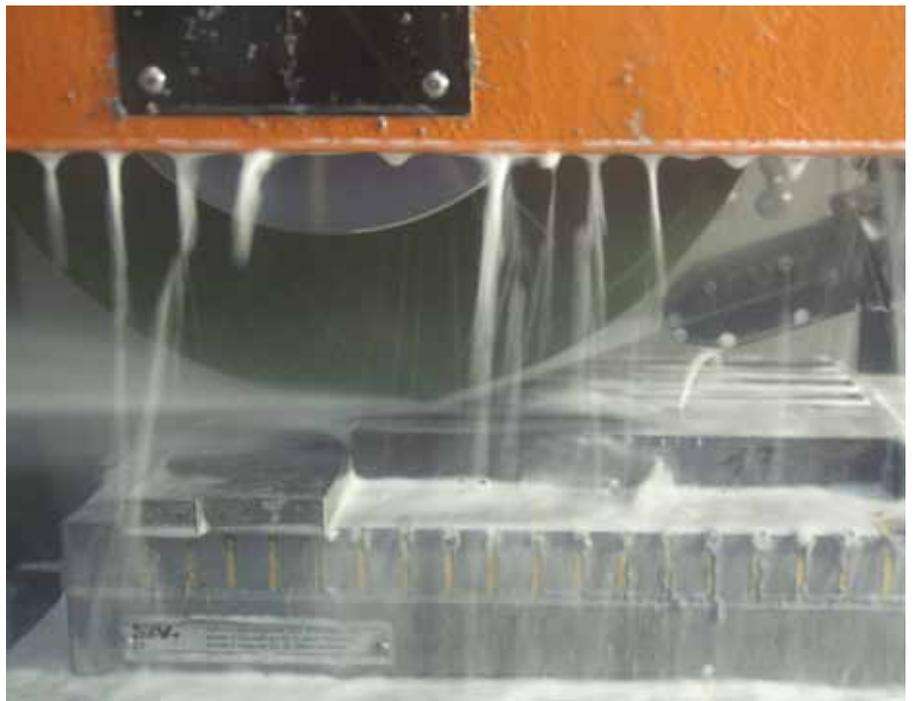
KSM - Düse mit integrierte Temperatur und Druckmessung. Bei der Micron-Reihe wird die Position der Kühlschmiermitteldüse automatisch der Schleifscheibe angepasst.
