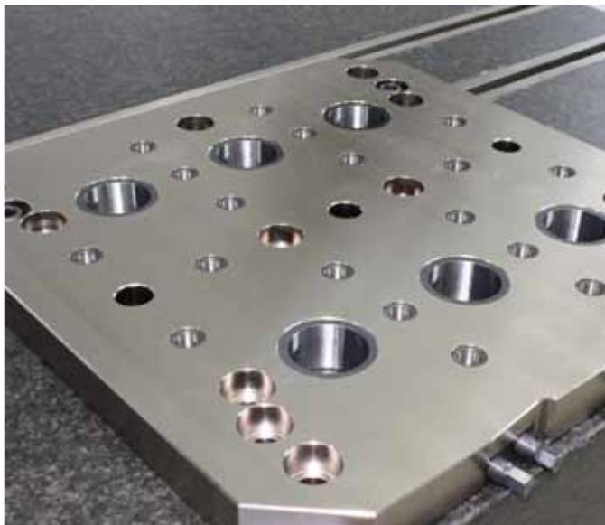
Die manuell bediente NRS-Platte ist für T-Nutentische geeignet und erlaubt ein Aufspannen unterschiedlicher Gressel-Spanner.
