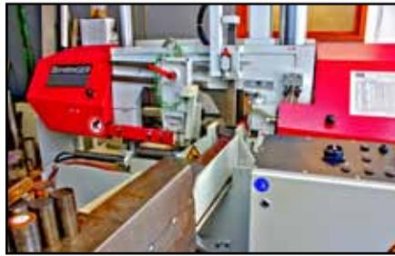
**Materialzuschnitt auf einer vollautomatischen Bandsägemaschine von Behringer.**
