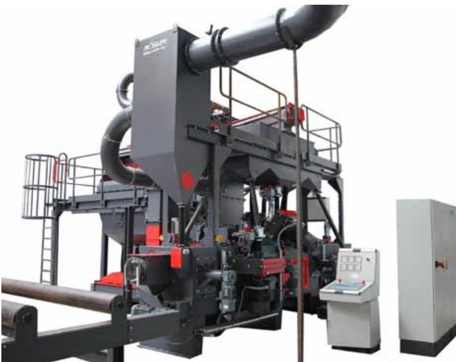
material-Stäbe trifft. Die Konzeption der Anlage mit Eingangs- Mittel- und Ausgangsstrahlkammer bietet verschiedene Vorteile. So wird verhindert, dass die Turbinen ineinander strahlen und die Teile beschädigen. Gleichzeitig ermöglicht diese Unterteilung, dass die für den Transport der Stahlstäbe erforderlichen Rollen in vom Strahlmittel abgeschirmten Bereichen untergebracht sind und dadurch deren Verschleiß minimiert wird.
