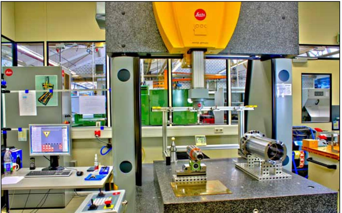
**Eine luftgelagerte Leitz-Messmaschine, die in einem Messraum der Güteklasse 2 steht, garantiert, dass nur 100 Prozent korrekt produzierte Teile in die Montage gehen.**
