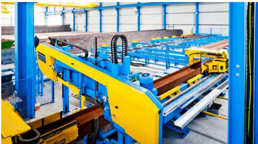
Vollautomatisches Anarbeiten von Stahlträgern: Die Anlage besteht aus einer leistungsstarken Gehrungsbandsäge, umfangreicher Peripherie zum Transport der Träger sowie einer Strahlanlage.
