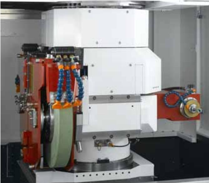
Die Schwenkbewegung des Schleifspindelstocks erfolgt per Direktantrieb, was eine Hirth-Verzahnung überflüssig macht.
