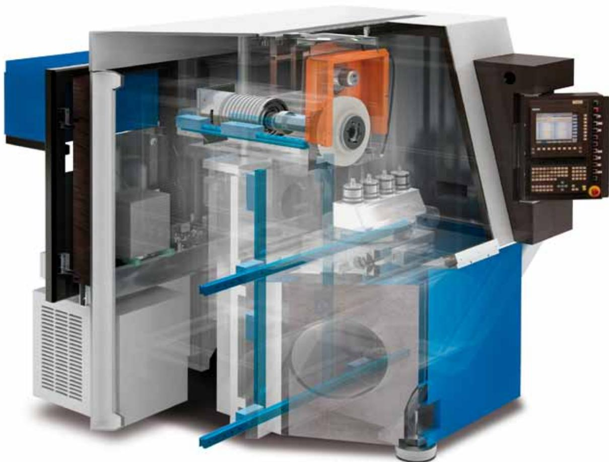
**Schnittansicht der Macro - Tiefschleifmaschine von Wolters. Maschinen der MACRO-Baureihe sind in allen Achsen mit hochpräzisen Linearführungen, Kugelumlaufspindeln und digitalen Antrieben ausgestattet.**
