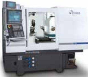
**Studers CT960 besitzt eine automatische B-Achse für präzises Positionieren.**
