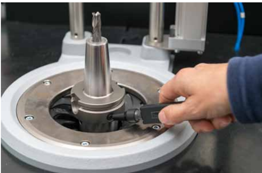
Im TDSc-Chip von Bilz können Einstelldaten für Schrumpfgeräte eingespeichert werden. Dadurch werden Schrumpfvorgänge absolut perfekt und ohne Werkzeugbeschädigung ausgeführt.
